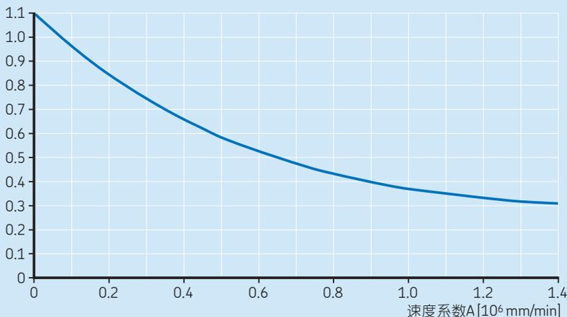
超精密轴承正常试运行时，所需的润滑剂数量最少，摩擦力矩最小，温度最低。轴承两侧聚拢的润滑脂将发挥储存器的作用，润滑油会流动到滚道中，长久的进行润滑。
